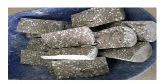
شكل (11) اشكال الكسر و الانهيار بالعينات بعد الانتهاء من اجراء اختبار الشد للخرسانة المحتوية على الزيت.
