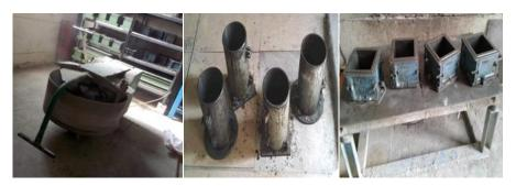
شكل (6) يوضح القوالب للعينات بعد تشحيمها و تجهيزها للصب مع الهزاز الميكانيكي و الخلاط المستخدم.
