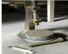
الشكل (9) يوضح عينة المونة المخلوطة مع الزيت و العينة الأخرى الغير مخلوطة بالزيت عند قياس زمنى الشك الابتدائي و النهائي.
