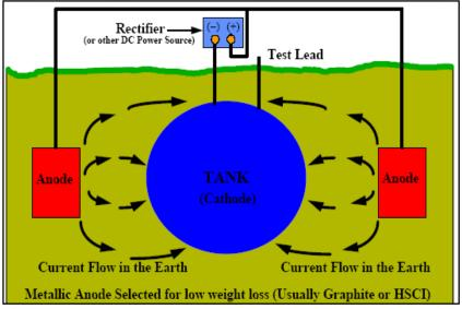
شكل (2) طريقة التيار المسلط
