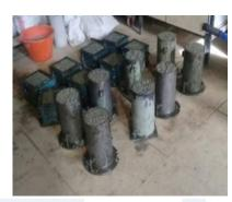
شكل (7) يوضح العينات في شكلها النهائي بعد الخلط و الصب دون اضافة الزيت ومع اضافة الزيت.
